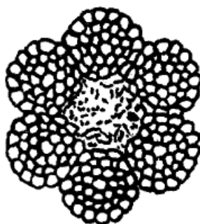
Рисунок 8. Уменьшение площади поперечного сечения проволок (интенсивная внутренняя коррозия)
